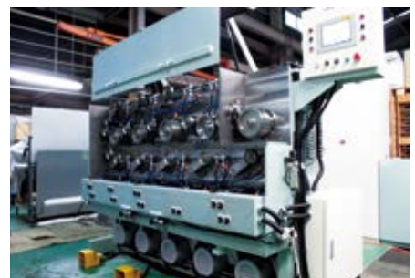
ノンスリップ式伸線機 様々な素材が湿式伸線機内部にある10数個の「ダイス」を通り極細線をつくり出しています
